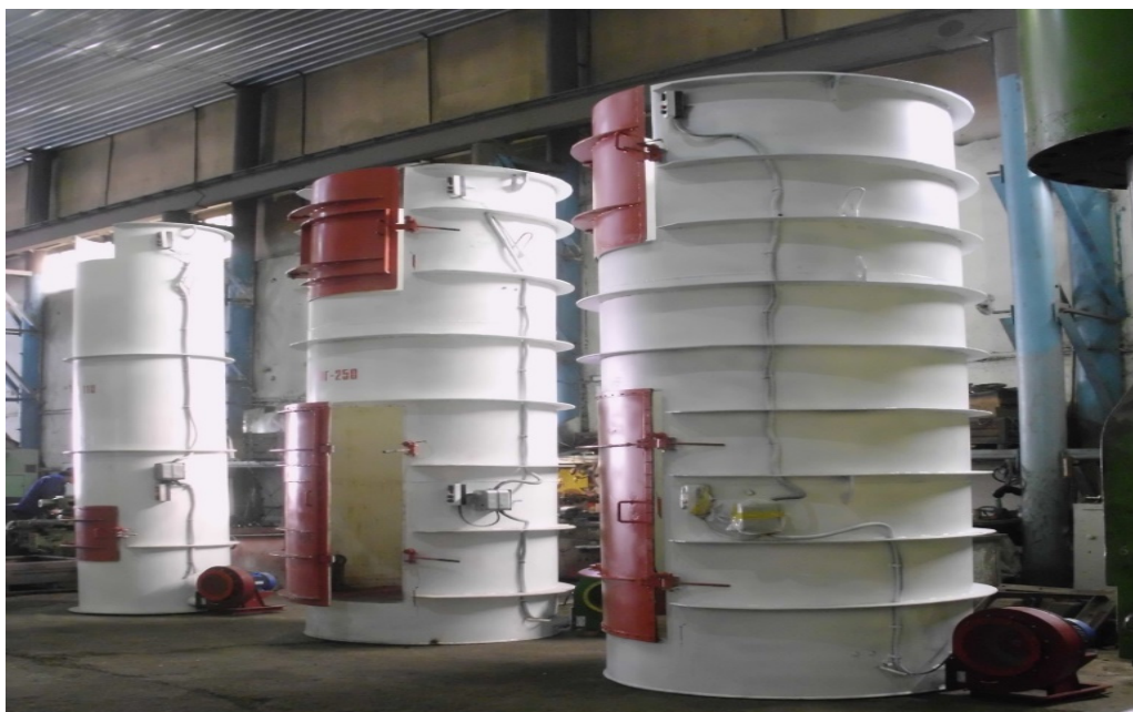
Рисунок 4 – Грузовые пневмолифты трёх модификаций грузоподъёмностью 110, 250 и 500 кг
