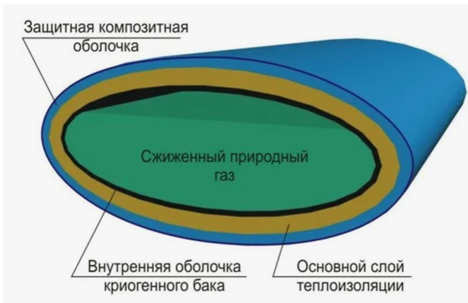
Рисунок 1 – Пример усиленной композитной оболочки
